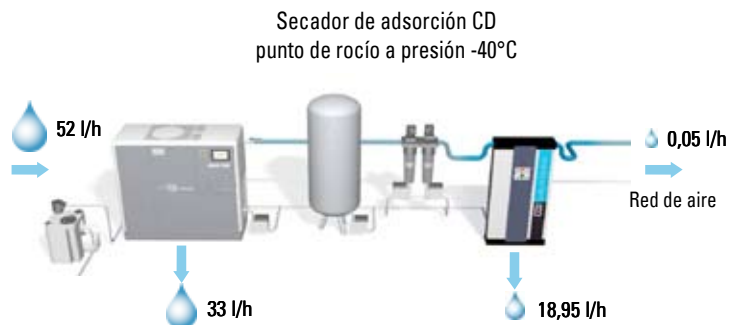
AGUA QUE ENTRA Y SALE DEL COMPRESOR Y SECADOR (EJEMPLO)
